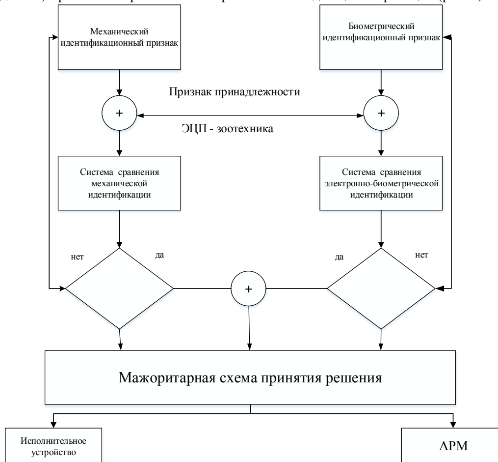
Рис. 1. Модель многоуровневой механической и электронно-биометрической идентификации животных
