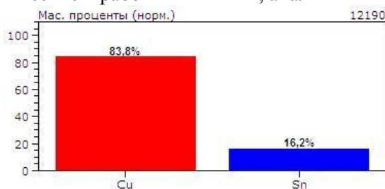
Рис. 3. Массовое процентное содержание химических элементов в сплаве плужного отвала
