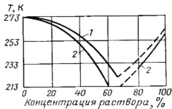
Рисунок 9 – Зависимость температуры замерзания водных растворов гликолей от концентрации: 1 – ДЭГ; 2 – ЭГ
