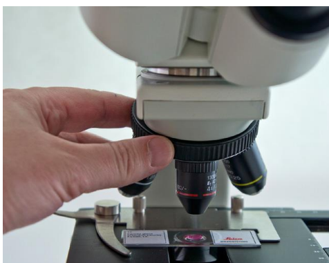
Рисунок 4. Начало работы – в рабочем положении стоит объектив 4×.
