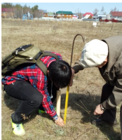
Рис. 1. Измерение протайки грунта щупом
