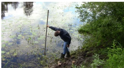
Измерение уровня воды в р. Луга на свайном водомерном посту
