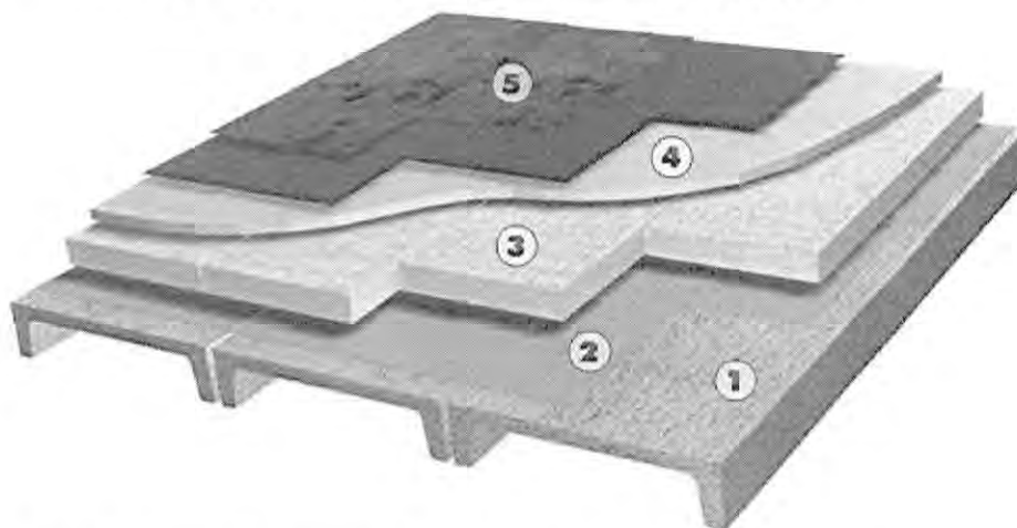
Рис. 15. Структура плоской кровли: 1 – плиты покрытия; 2 – слой пароизоляции; 3 – слой утеплителя; 4 – железобетонная стяжка; 5 – слой гидроизоляции (рулонной или наплавляемой)
