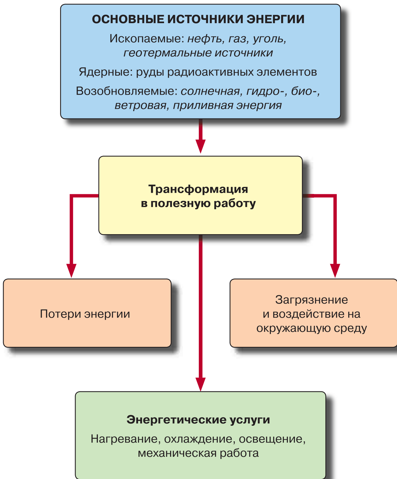
Рис. 4.1. Схема процесса передачи и трансформации энергии от энергоисточника к потребителю
