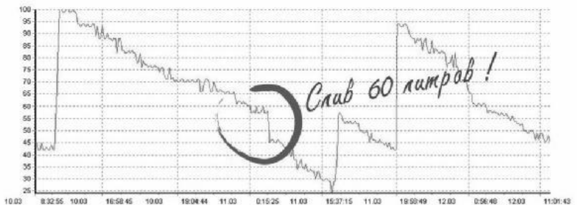
Рисунок 4.61. Выявление хищения топлива по графику расхода
