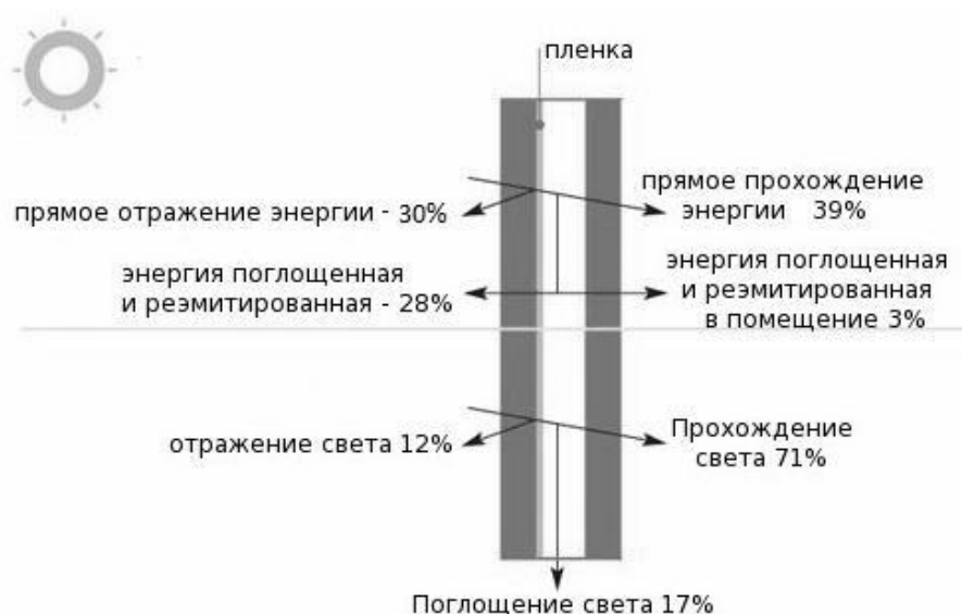
Рисунок 4.23. Иллюстрация селективного отражения и пропускания излучения в видимом и инфракрасном диапазоне
