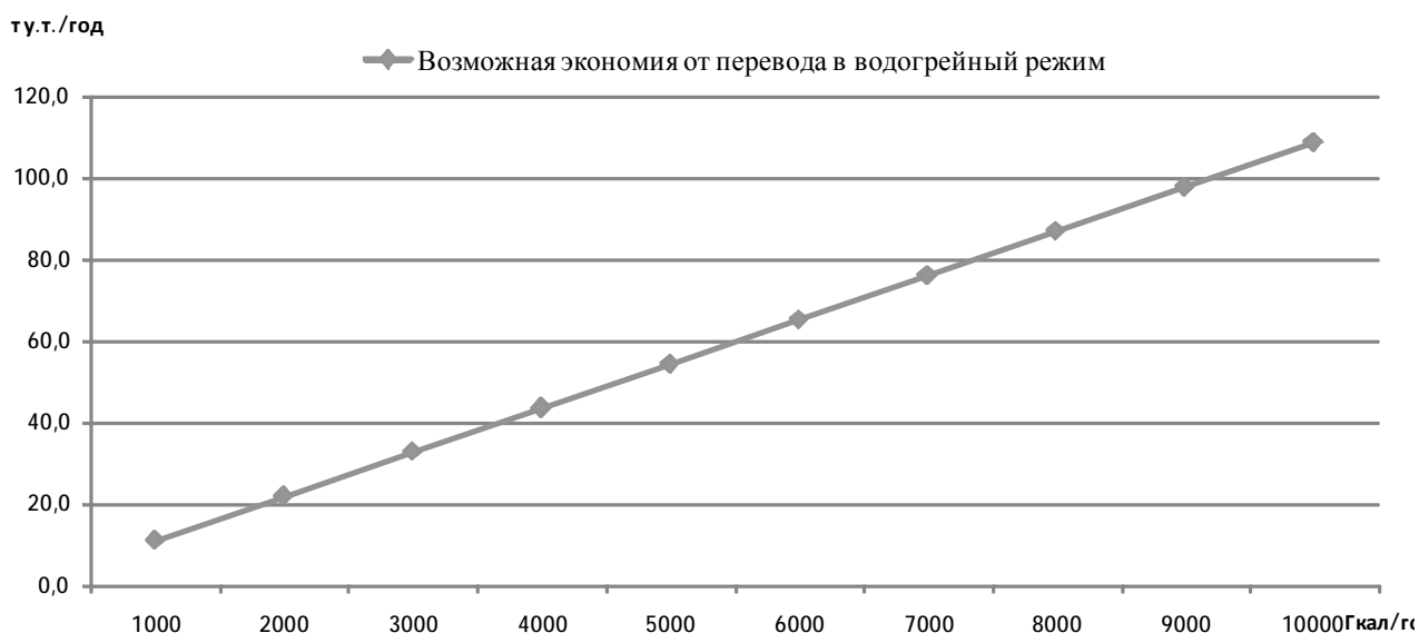
Рисунок 4.54. Эффект от перевода паровых котлов в водогрейный режим
