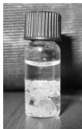
Рис. 2. Кристаллы рацемата миндальной кислоты, полученные в результате перекристаллизации
